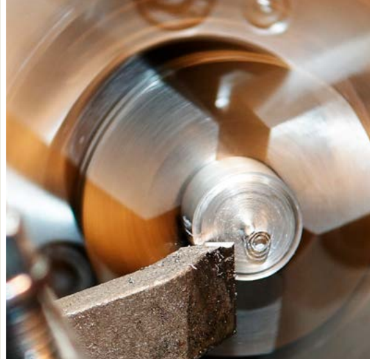
Выточки для беспаячных трубных соединений (DIN 3854/ DIN 3862)
