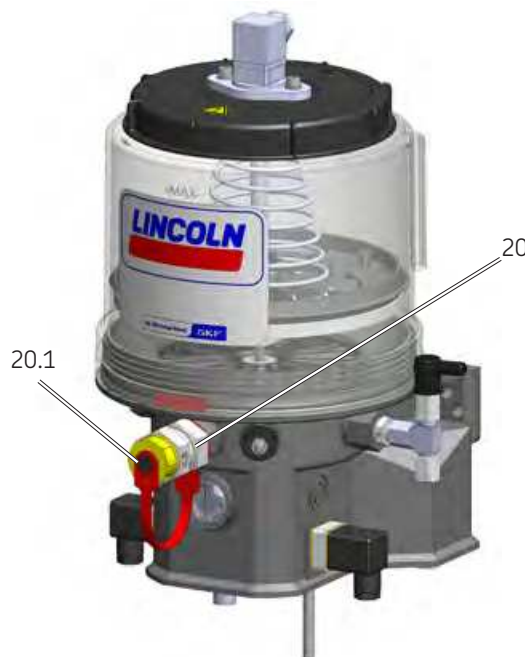
Рис. 15.3 Заполнение через опциональный заправочный штуцер
