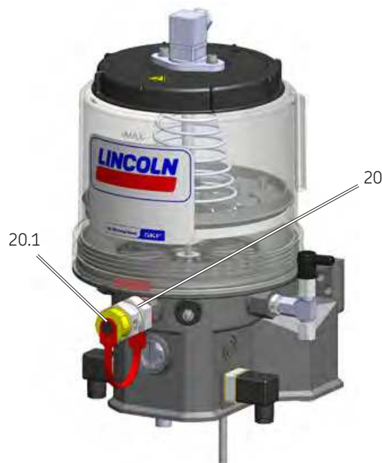
Рис. 14. 3 заполнение смесочным маслом через заправочный штуцер
