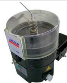
Рис. 18. Емкость снова смонтирована
