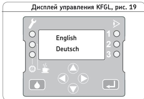
Устройство упр вления имеет трехстрочную индикацию, каждая строка длиной 8 символов. В окнах меню, имеющих более 3 вариантов выбора, отображаются только 3 из них. Дополнительные варианты можно вызвать с помощью клавиш со стрелками <вниз/вверх>.
