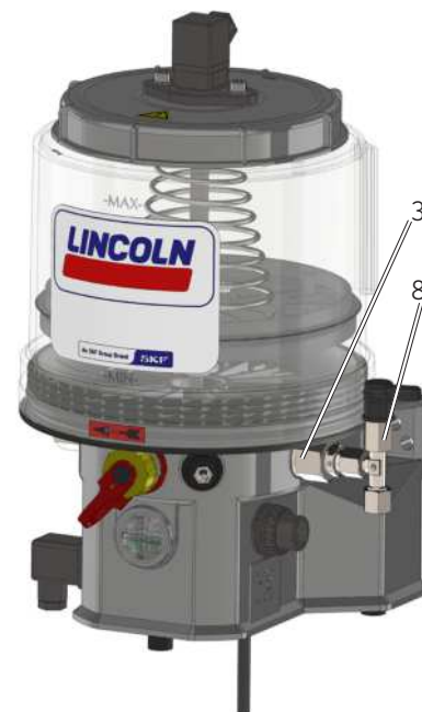
Рис. 20.3 Замена насосного элемента
