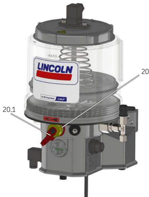
Рис. 15.3 Заполнение смесочным маслом через заправочный штуцер
