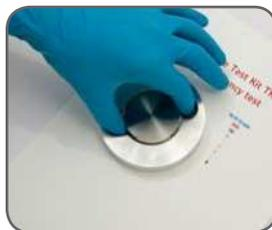
11. Возьмите груз и вторую стеклянную пластину, поместите стеклянную пластину под груз и плавно опустите в корпус. Груз не должен касаться смазки!
