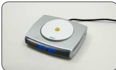
6. Базовое масло впитается в бумагу. Через два часа (можно воспользоваться таймером нагревателя) аккуратно снимите промокательную бумагу с нагревателя и удалите с неё смазку.
