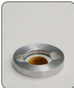
5. Осмотрите образец невооружённым глазом на предмет наличия частиц, неоднородности, неравномерной прозрачности, твёрдых частиц, сгустков и т. д. Результаты осмотра станут дополнением к первому визуальному осмотру. При наличии образца чистой смазки проведите их сравнение.
