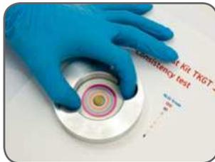
10. Поместите корпус на калиброванную шкалу, вставьте стеклянную пластину в корпус смазкой вверх (смазка не должна быть на стороне, прилегающей к бумаге!) – Выровняйте пятно пластичной смазки по центру шкалы.
