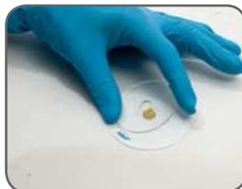
5. Поместите промокательную бумагу с образцом смазки на нагреватель на два часа. Удерживайте бумагу за края и не касайтесь нагревателя.
