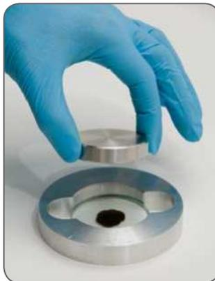
4. Нажмите на груз, чтобы смазка растеклась ещё сильнее, а затем уберите груз. Слой пластичной смазки станет очень тонким (около 100 микронетров).
