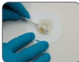
7. Оставшееся пятно будет иметь слегка эллиптическую форму. Это происходит из-за направленности волокон бумаги. Для большей точности измерьте больший и меньший диаметр с помощью линейки (в миллиметрах) и определите среднее значение.
