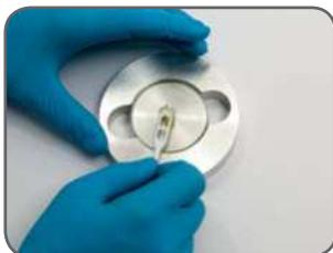
7. Нанесите пластиковую смазку на маску. Убедитесь, что отверстие заполнено смазкой, и сотрите излишек смазки с верхней части.
