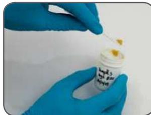
6. Возьмите образец для анализа из контейнера для образцов с помощью одноразового шпателя
